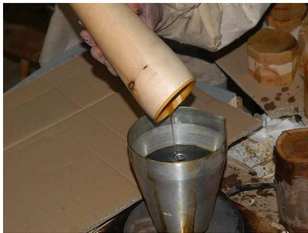
Ist die gesamte Innenseite unseres Weißbierholzes mit dem Pech benetzt, und der Überschuss zurückgeschüttet, sollte das Gefäß nun zum Abkühlen an einem ruhigen, staubfreien Platz abgestellt werden.
