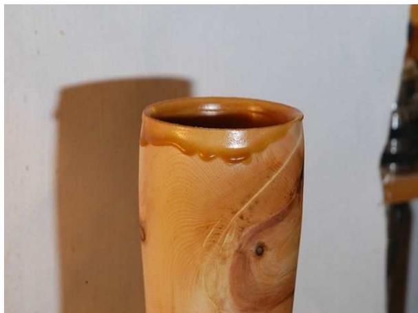
Das nach Außen gelaufene Pech kann nach dem Abkühlen leicht mechanisch abgeschält werden, da es ja auf dem bereits eingeölten Holz lange nicht so gut haftet, wie auf dem unbehandelten Innenraum
