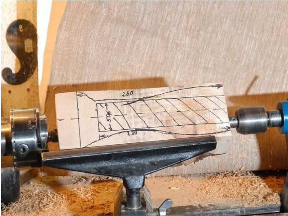
Nun wird sie mit der Schruppröhre zu einem Zylinder geformt
