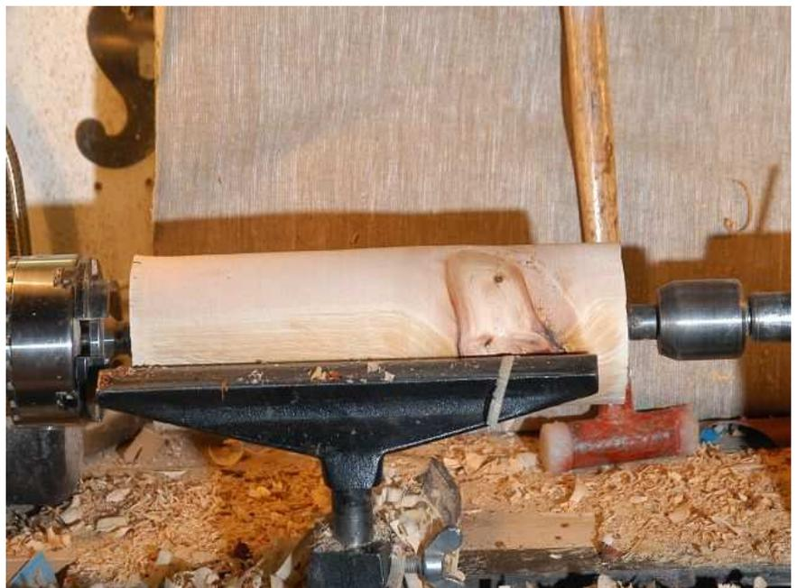
Am Fußende wird zum späteren Einspannen in das Backenfutter ein Zapfen angedreht
