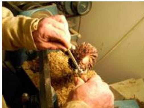
Schon bei der kleinsten Berührung mit dem drehenden Sternschleifer rotiert die Messingtülle auf dem Haltedorn und gewährleistet so einen gleichmäßigen Abtrag der Oberfläche. Auf diese Weise wird in Sekundenschnelle das Messingröhrchen fettfrei geschliffen und haftet beim Einkleben in den Rohling wesentlich besser.
