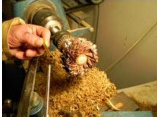
Der Sternschleifer wird in einem Bohrfutter in die Drechselbank eingespannt. Auf einen abgeschnittenen alten Schraubenzieher mit 5 mm  $\varnothing$  stecke ich die Messinghülsen.
