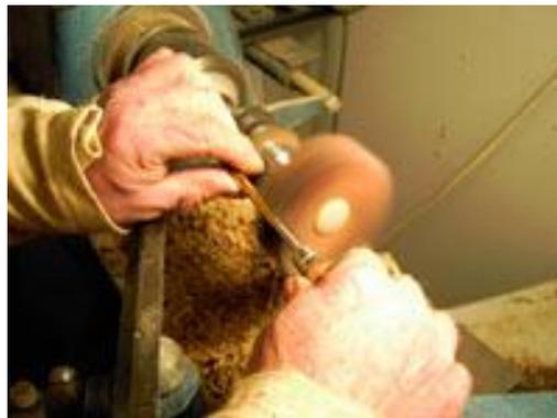
Das ganze wird dann bei laufendem Antrieb an den Sternschleifer gehalten. Durch seine raffinierte Verklebung plustert er sich beim Drehen auf und so entsteht ein Schleifkörper, der in jeder Lage nachgibt und keine Rillen oder Macken in das dünne Rohrchen schleift
