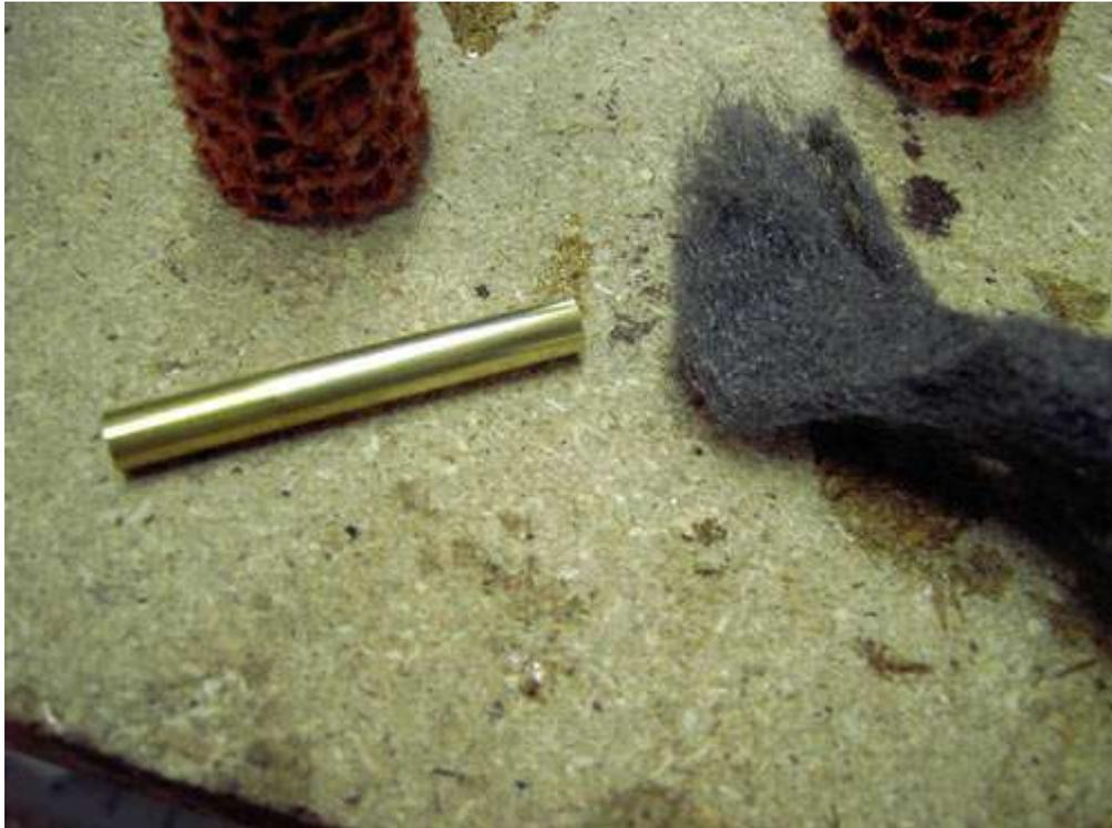
Danach werden die Enden mit dem Zentrierbohrer rechtwinkelig abgefräst
