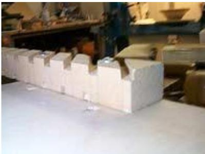
Aus einem Stück Fichtenholz schnitt ich auf der Kreissäge die vorher berechneten Führungsnuten für meinen Abstechstahl aus. Die Schräge beträgt ca.  $45^\circ$  für eine Brettdicke von 30 mm.
