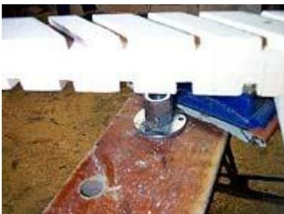
Eine Unterkonstruktion zum Befestigen auf der Drechselbank war einfach herzustellen.
