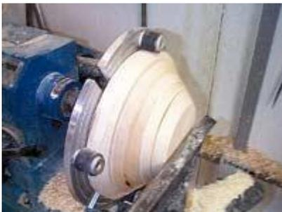
Nun wird der Rohling aufgespannt
