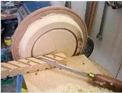
Nun wurde, geführt durch die schrägen Nuten ein Ring nach dem Anderen abgestochen
