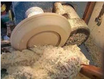
Wenn der Abstechstahl schön scharf geschliffen ist, entstehen sehr lange und dünne Späne.
