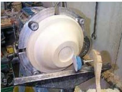
Im Schalenboden wurde ein Rezzus zum Umspannen hergestellt und die äußeren Konturen der Schale können geschnitten werden. Auch die ersten Schleifarbeiten können erledigt werden
