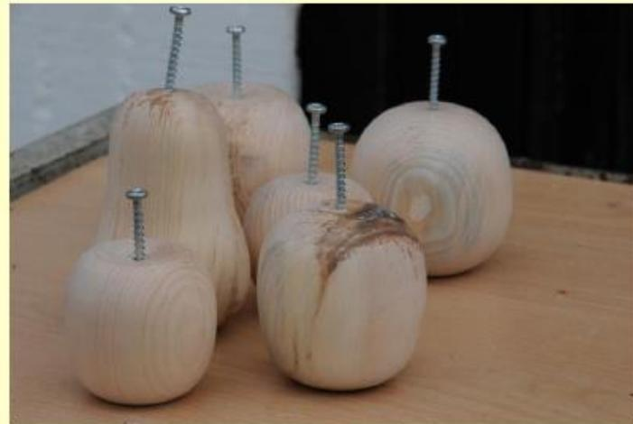
Zur farblichen Weiterbehandlung wird in das obere Bohrloch eine Schraube als Griff eingesetzt.
