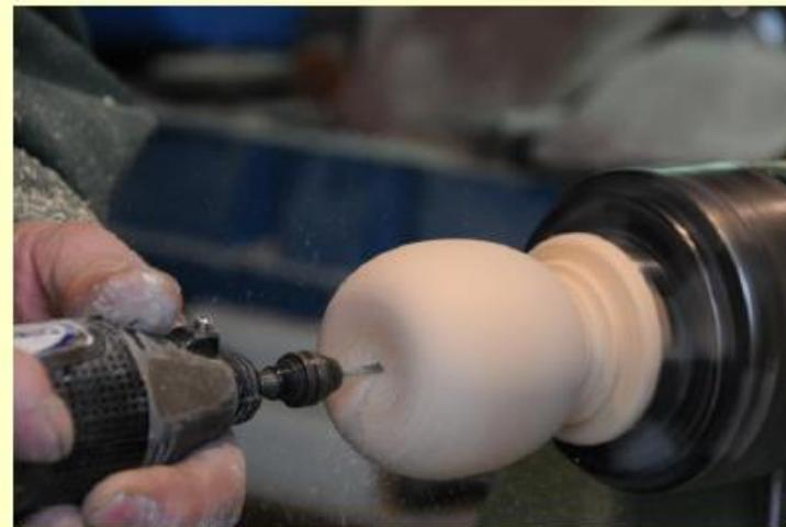
**Nun wird im Zentrum eine Bohrung  $\Phi$  3 mm eingebracht. Je genauer dieser Schritt ausgeführt wird, um so runder läuft bei der nächsten Aufspannung das Werkstück. Also möglichst mit Reitstockunterstützung bohren.**
