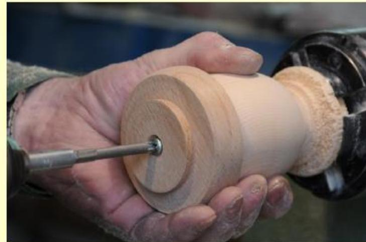
**Zwischen Futter und Werkstück sollte ein Stück Schleifpapier eingeklemmt werden, um die Haftung zu verbessern. (Lässt sich nach Fertigstellung auch wieder leichter lösen).**
