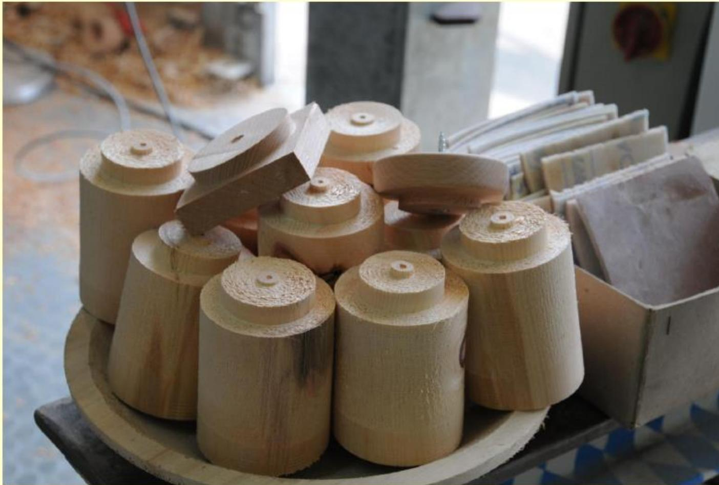
**Zuerst werden passende Hölzer ausgesucht und zugerichtet. Wir verwenden hier Zirbelholz,  $\Phi = 85 \text{ mm}$   $L = 120 \text{ mm}$ .**
